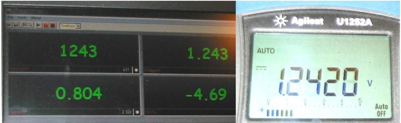
La valeur analogique est affectée par le courant d'alimentation de l'électronique du DigiLSU (40mA). La masse analogique doit être la plus courte possible pour avoir une meilleure précision.
